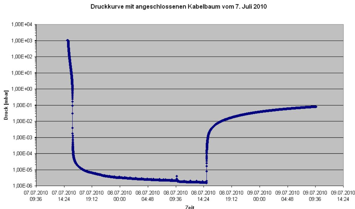
Abbildung 24: Gesamter Druckverlauf bis zur Sättigung bei  $10^{-1}$  mbar der bereits in Abbildung 23 angeführten Messung.
