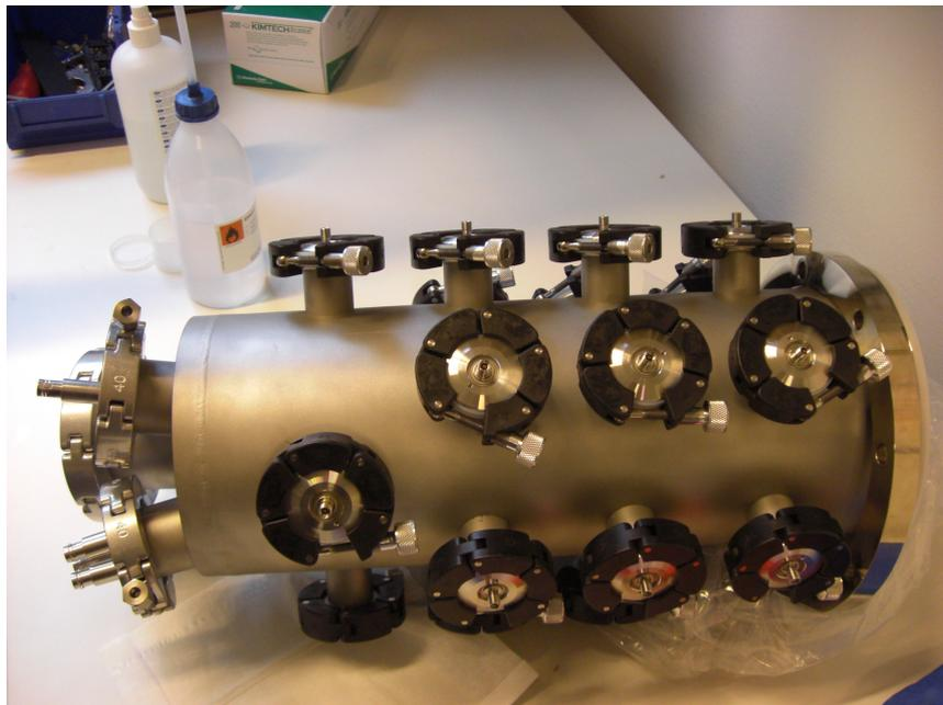
Abbildung 22: Der Kabelbaum mit seinen erdfreien Durchführungen
