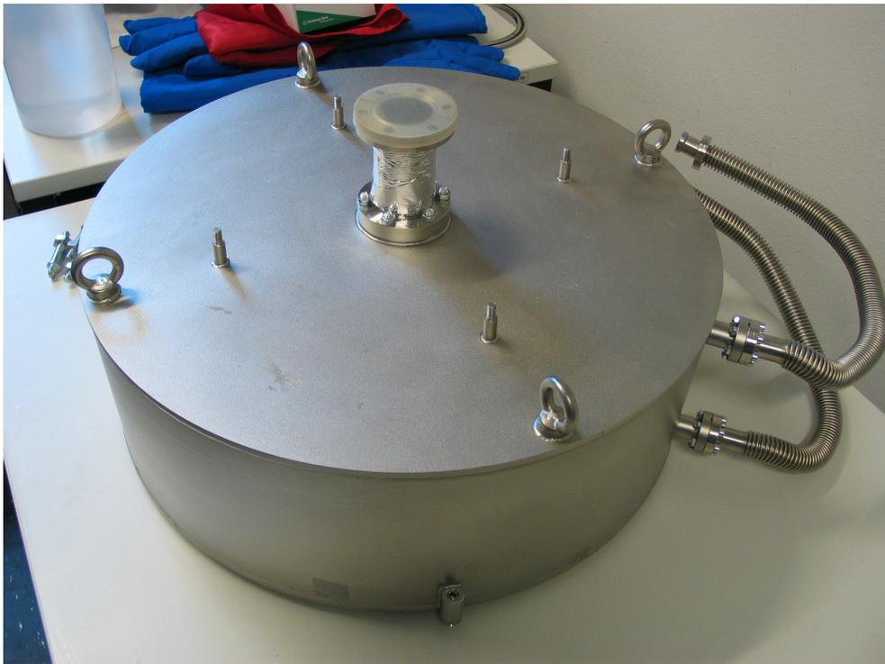
Abbildung 31: Der Kryotank mit den Henkeln zur Aufhängung, den Wellschläuchen und der Durchführung für den Kühlfinger außerhalb des Tanks
